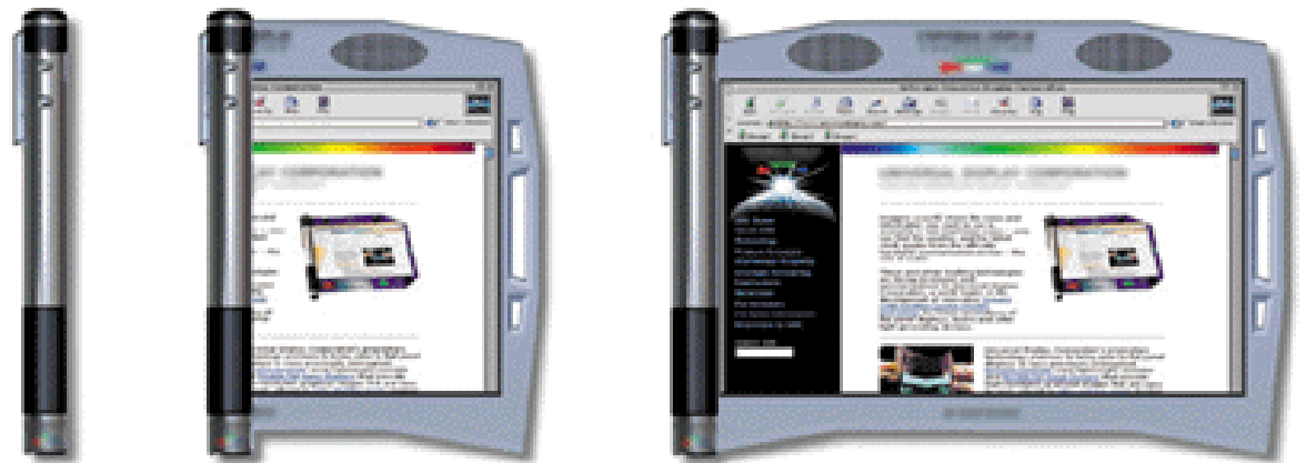
圖一：滾捲式包裝筆型網際網路隨身顯示器。它的製造結合了來自加州聖荷西 Vitex Systems 的塗有保護層的基材與特有的膠囊包裝、UDC 的磷光 OLED 技術、德國阿亨市 Aixtron AG 的有機氣相沈積技術與可撓式複晶矽背板、非晶矽、CdSe 以及有機薄膜電晶體。
